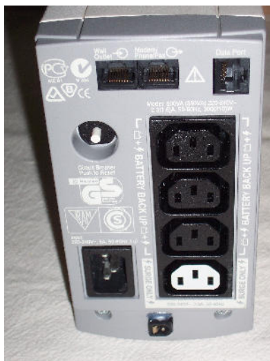
Aspecto do panel traseiro do SAI co conector xa instalado
