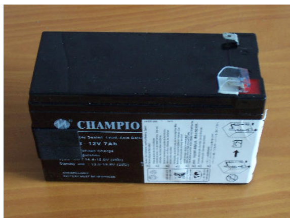
Batería de chumbo-ácido de 12V, 7Ah
