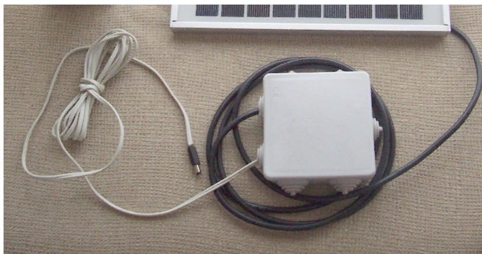
Cables de conexión panel-regulador y regulador-SAI
